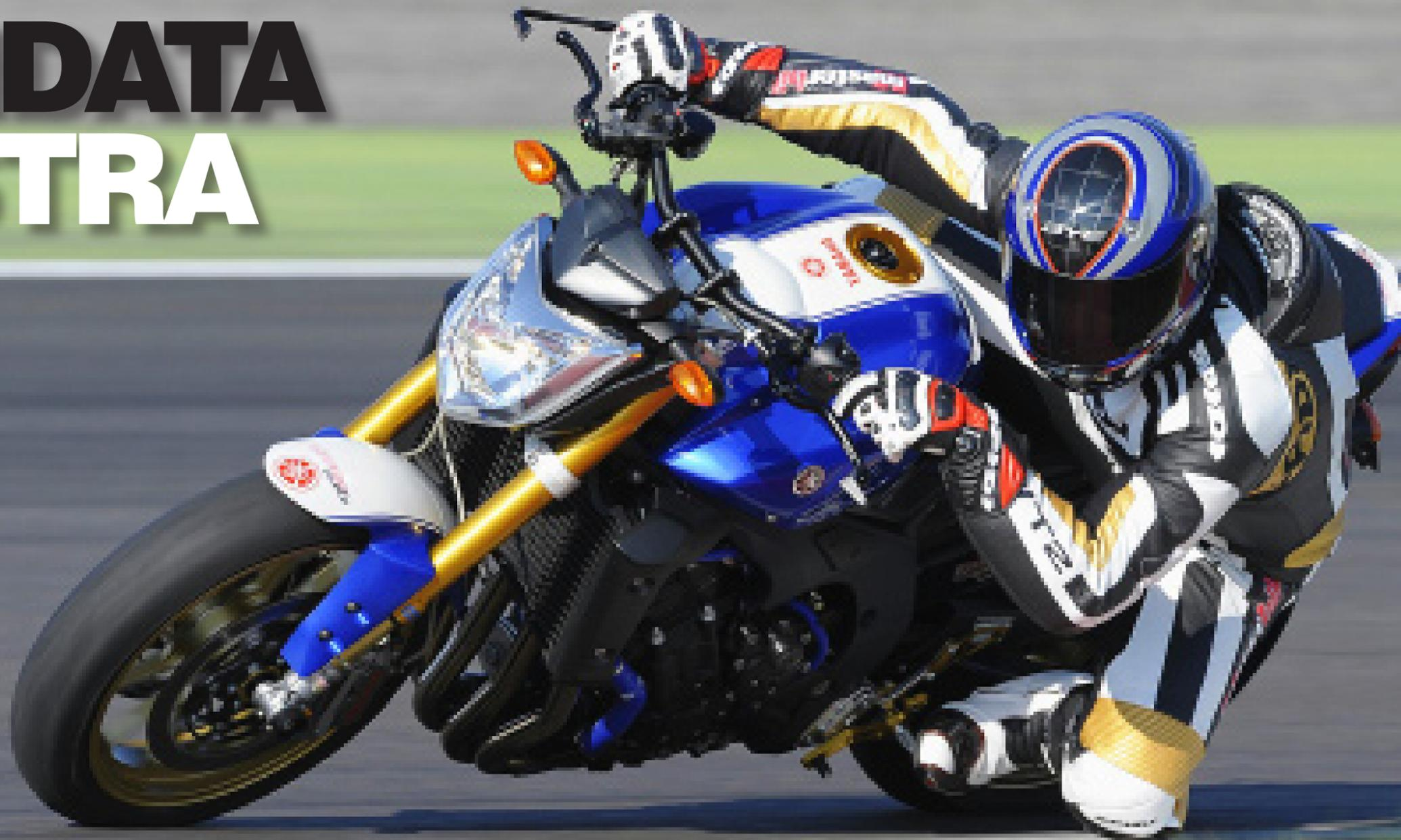
“griffata” da capo a piedi. L'insieme, prevede una pompa radiale Brembo RCS, un tubo in treccia metallica della HEL, e dischi racing T-Drive di 310 mm Ø Brembo, che vengono morsi da pinze radiali monoblocco della medesima marca. Queste sono state adattate alla forcella tramite dei supporti realizzati appositamente al controllo numerico. Un avantreno del genere conferisce a questa FZ1 un aspetto solenne, che prelude una vigoria ciclistica da vera sportiva.
